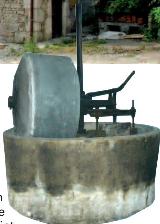
Meuleton et cuve en pierre pour écraser les cerneaux de noix
