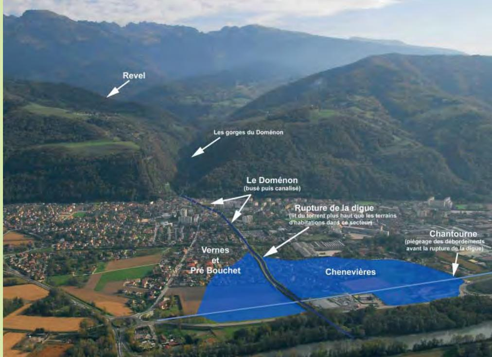
Les travaux d'urgence de renforcement des digues du Doménon ont permis d'augmenter la capacité de son lit pour permettre une meilleure protection contre les crues. Avant la crue d'août 2005, la capacité du lit du torrent était trop faible pour des crues de fréquence 10 à 30 ans.
